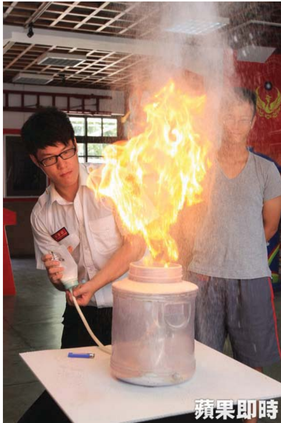
白色粉末狀是奶精粉，實測時火苗直竄而上燃燒。楊勝裕攝
