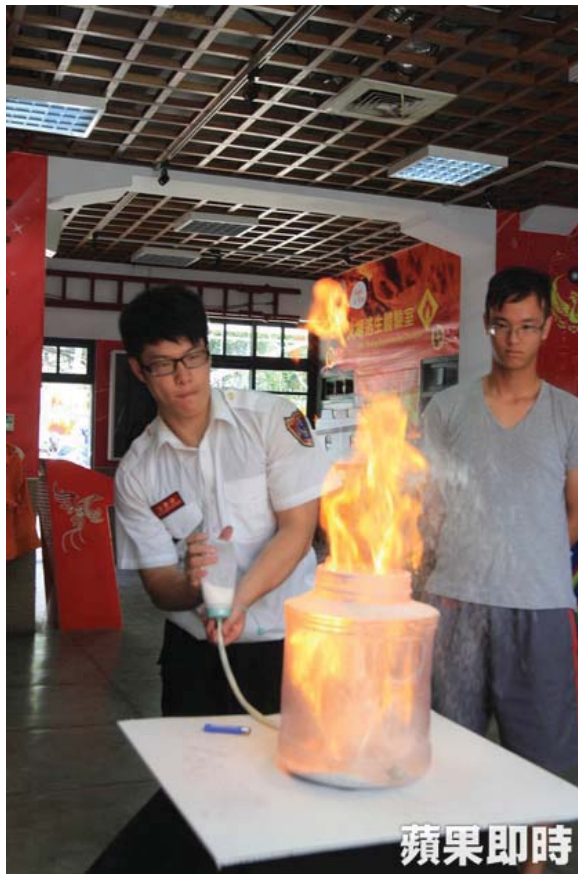
奶精粉噴灑在空桶內，在桶內造成塵爆，也往外擴散。楊勝裕攝
